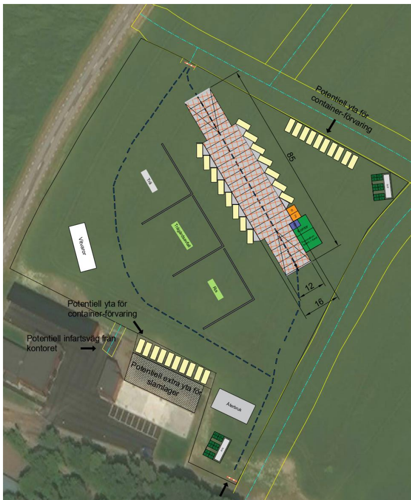
Figur 2. Situationsplan över verksamhetsområdet med placering av containrar och uppställningsytor. Observera att detta är ett förslag på utformning från Söderköpings kommun som kan komma att justeras.
