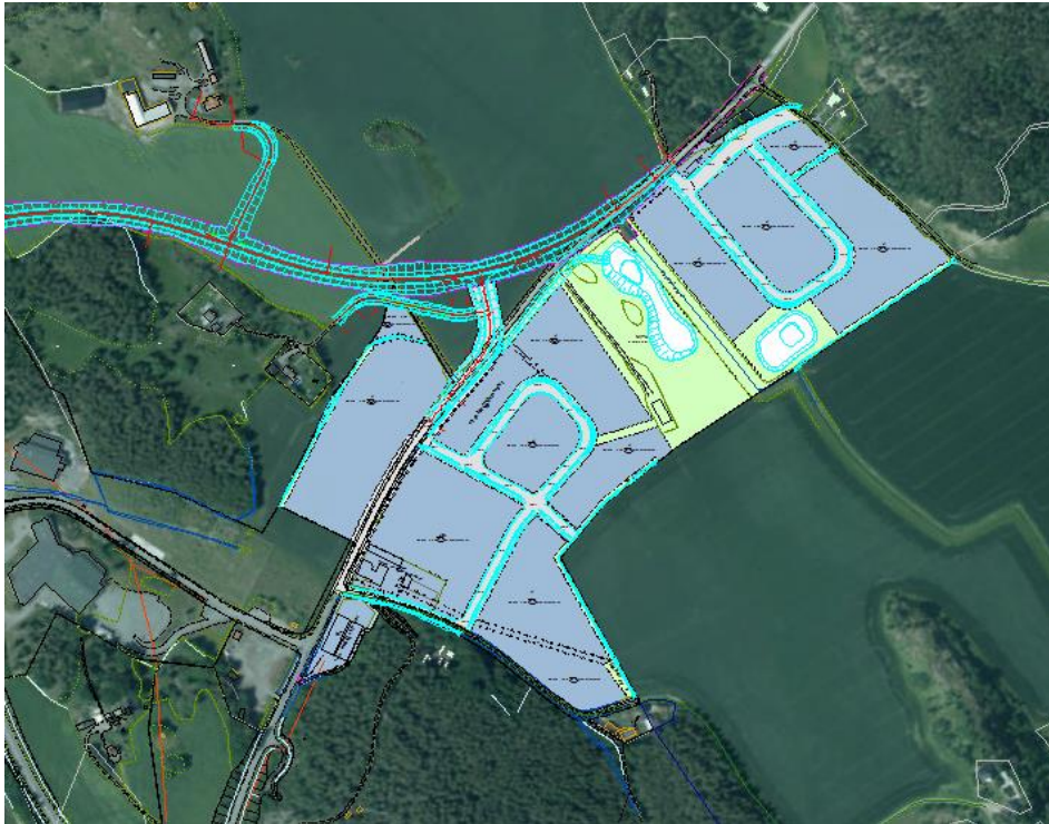
Bild 9. Bild där projekteringsunderlag för nya vägar (ljusblå linjer) och dagvattendammar (ljusblå linjer inom gröna ytor) illustreras ovanpå ortofoto och plankartan.
