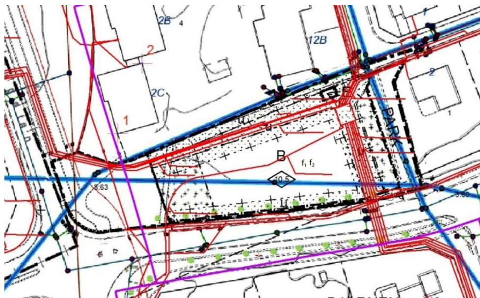
Ledningskarta; VA-ledning (blått), fjärrvärme (lila), gatubelysning (rött)
