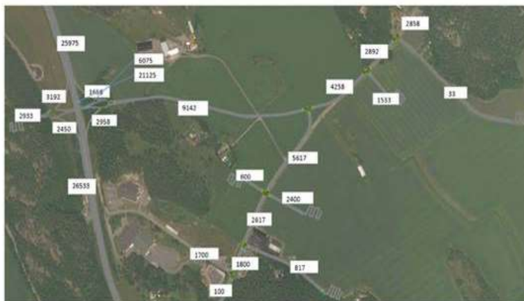
Figur 16. Dygnsflöden trafik i och kring detaljplanen 2040. Källa: WSP 2019.
