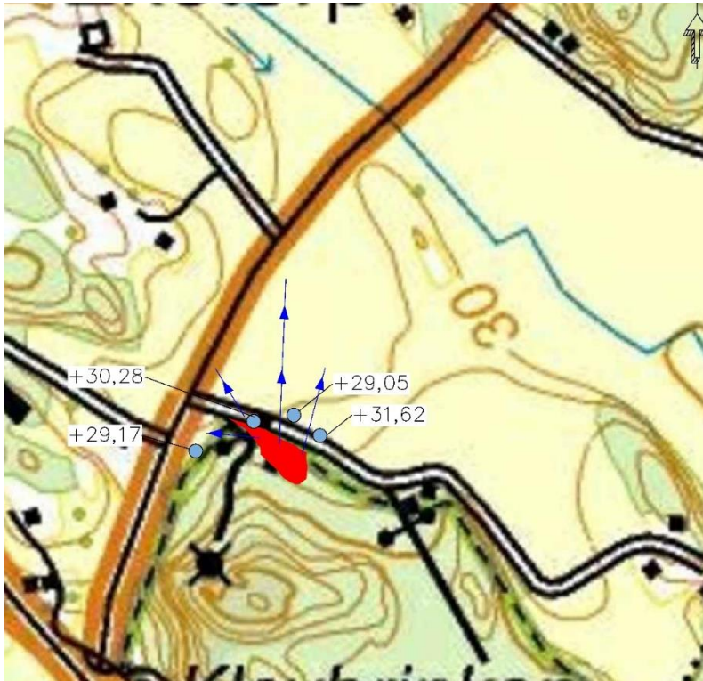
Figur 3. Deponin Pettersburg II:s utbredning i rött och bedömd flödesriktning grundvatten. Grundvattennivåer i grundvattenrör anges i höjdsystem RH2000 och är hämtade från AFRY:s tidigare undersökning.
