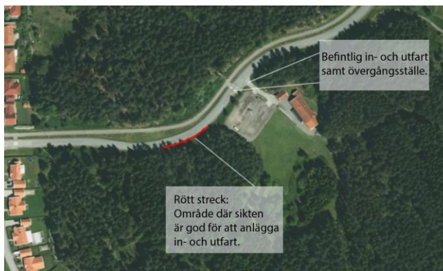
Bild 11: öster i bild syns befintlig in-och utfart samt övergångsställe vid SOK-stugan. Det röda strecket väster om befintligt är en sträcka om cirka 40 meter där ny in- och
