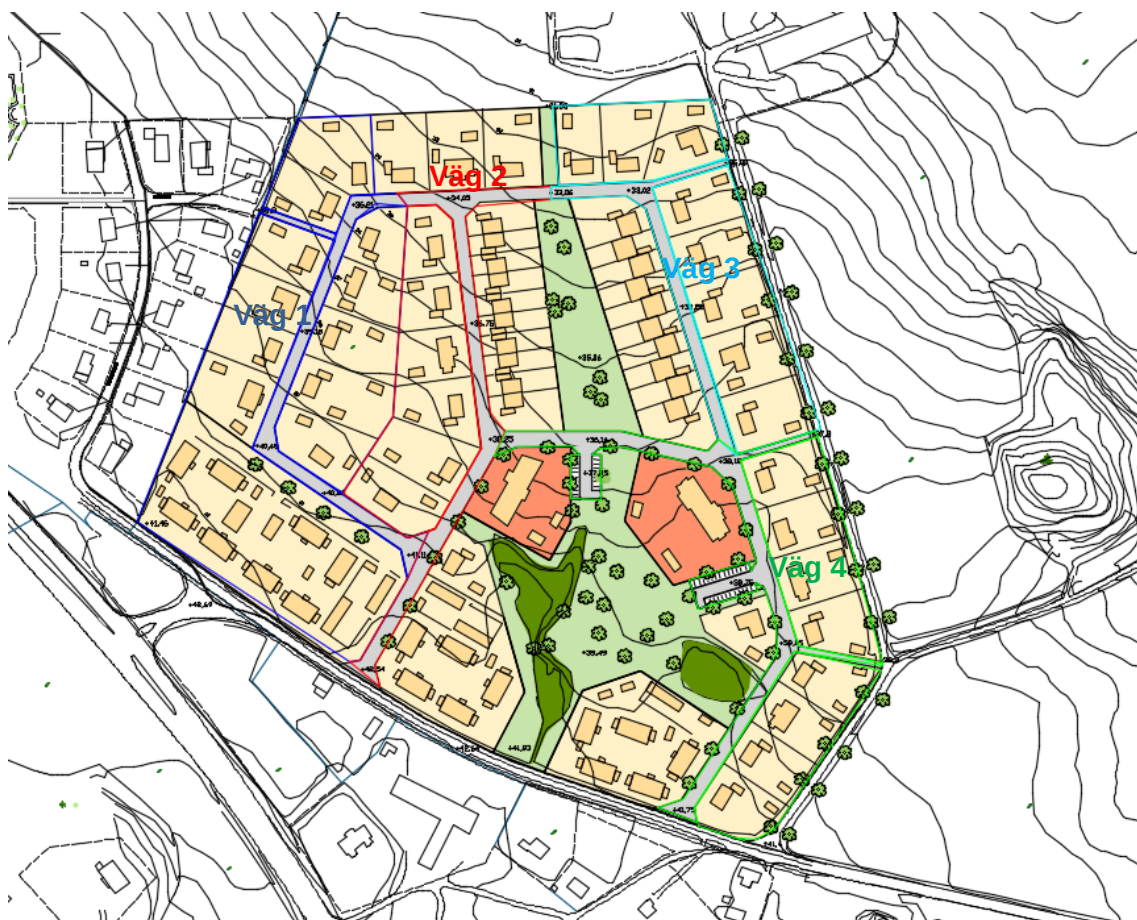
Figur 9. Indelning av vägarna utifrån förväntade flöden. Observera att denna indelning inte är densamma som i förprojekteringsritningarna.
