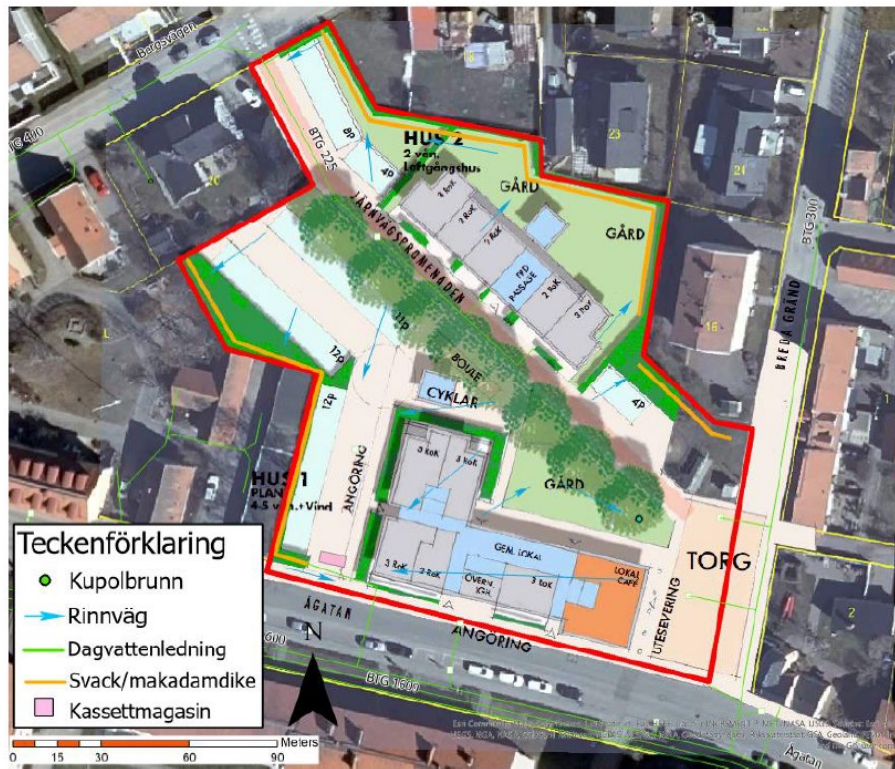
Figur 9 Principlösning på dagvattenbantering. Källa: Dagvattenutredning, Tyréns AB
