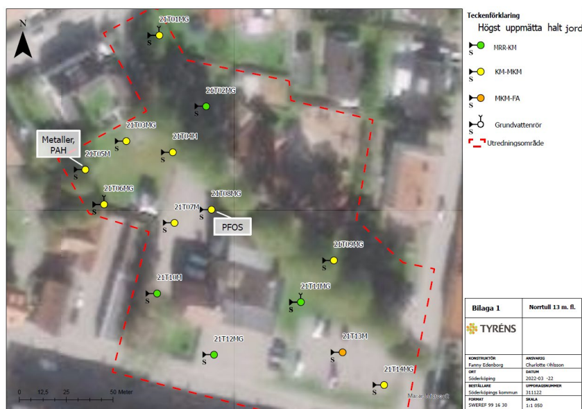
Figur 14 Provtagningspunkter. Källa: Miljöteknisk markundersökning, Tyréns Sverige AB.
