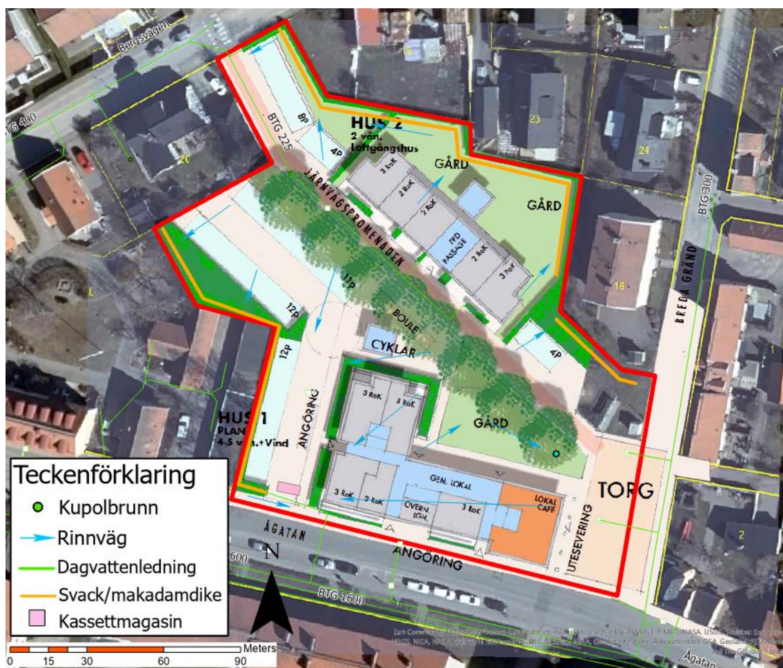
Figur 10: Principlösning på dagvattenhanteringen till detaljplanen för Norrtull 13 mfl.
