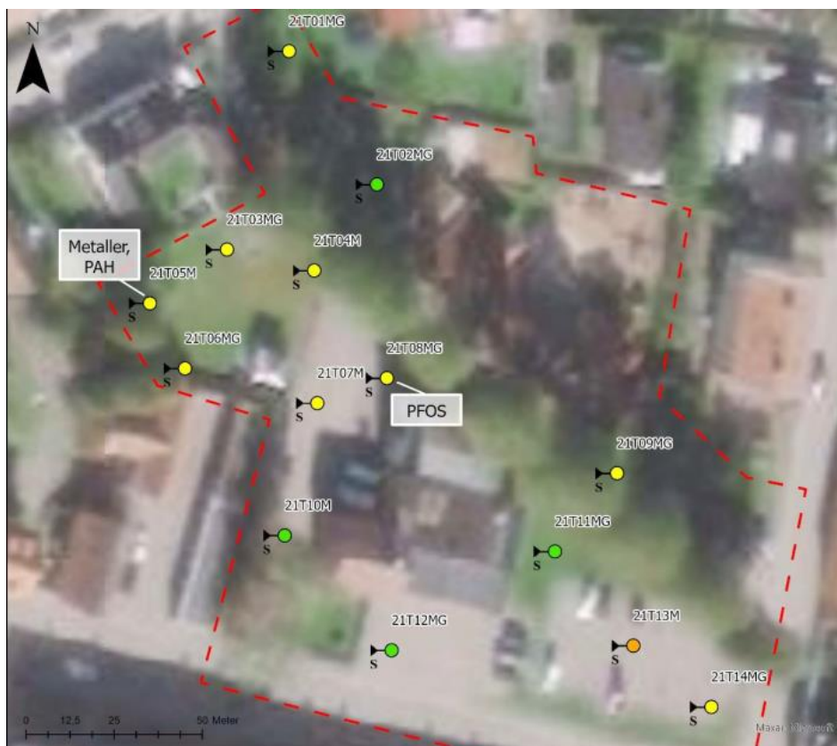
Figur 6. Provpunkter i jord. I samtliga gulmarkerade provpunkter utom i 21T08MG, uppmättes metaller i halter överstigande KM, i provpunkt 21T05M uppmättes även halter av PAH-H över KM. I provpunkt 21T08MG påträffades istället PFOS i halter överstigande riktvärdet för KM. Bild hämtad från miljöteknisk markundersökning (Tyréns, 2021)
