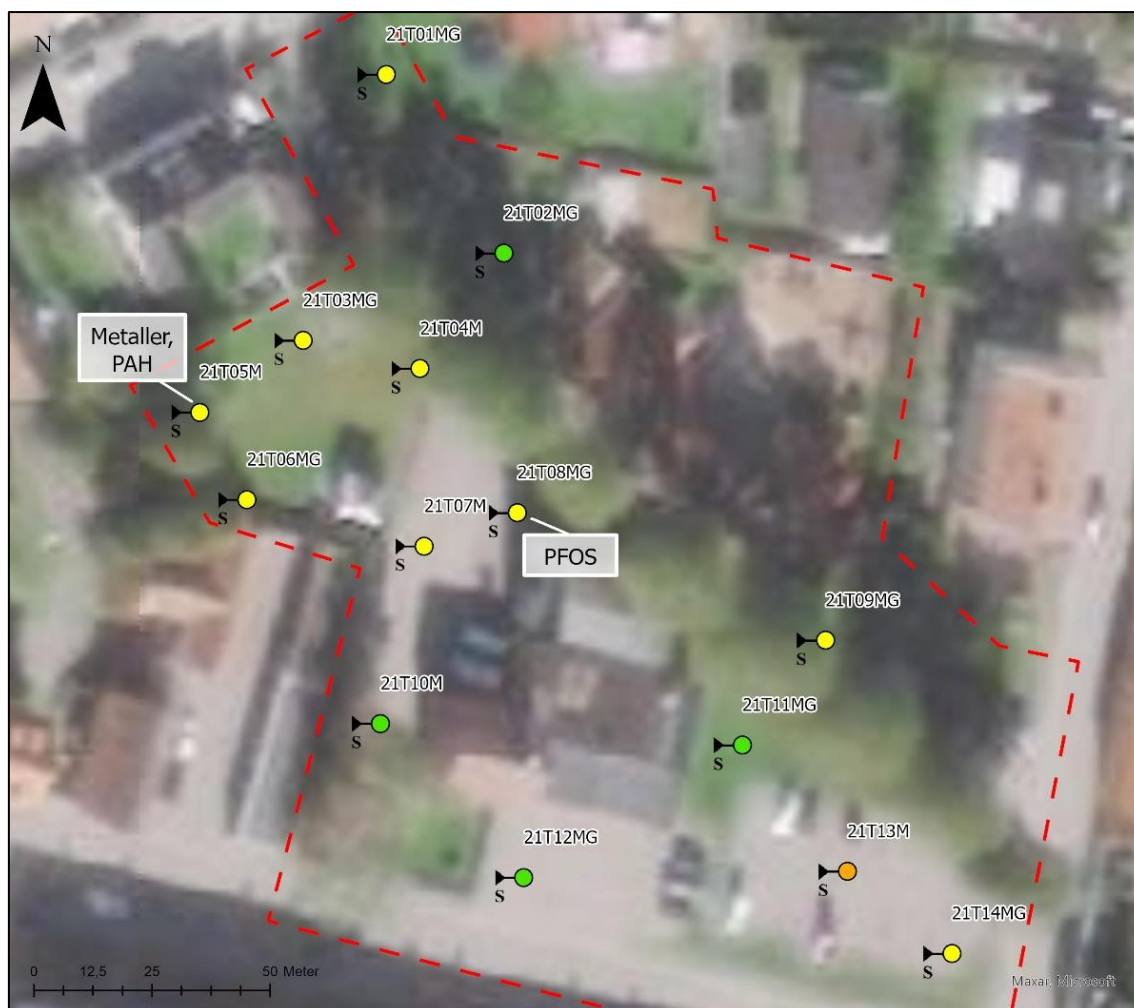
Figur 6. Högst uppmätta halt i jord oavsett djup i samtliga provpunkter. I samtliga gulmarkerade provpunkter, utom i 21T08MG, var det metaller som uppmättes i halter överstigande KM, i provpunkt 21T05M uppmättes även halter av PAH-H över KM. I provpunkt 21T08MG påträffades istället PFOS i halter överstigande riktvärdet för KM.
