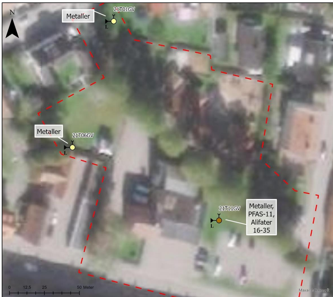
Figur 7. Högst uppmätta halt i samtliga tre grundvattenrör som installerades. Gul punkt= måttlig halt av metaller. Brun punkt= Överskridande riktvärde för metaller, PFAS-11 och alifater.
