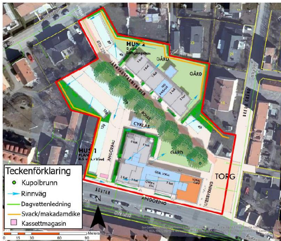
Figur 7 Principlösning på dagvattenhantering. Källa: Dagvattenutredning, Tyréns AB
