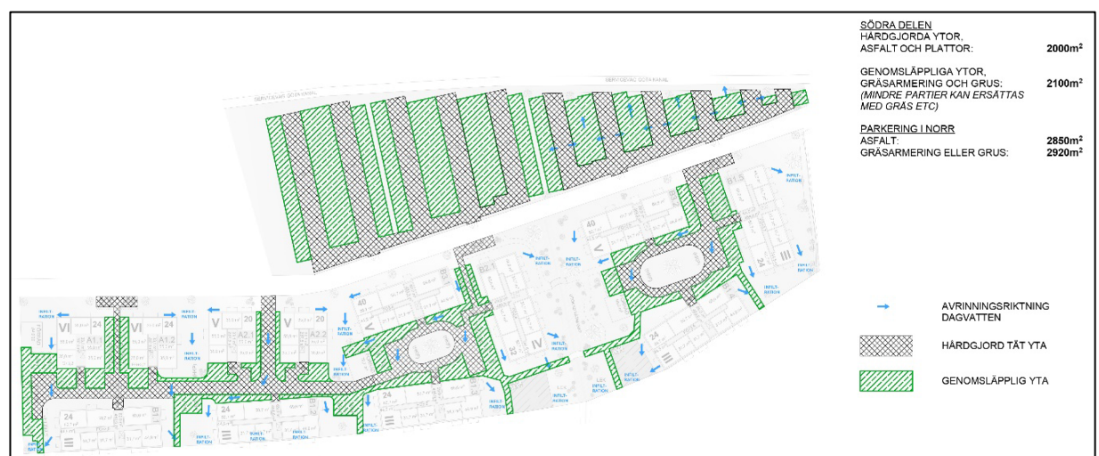
Bild 32. Principskiss över föreslagen dagvattenhantering inom planområdet som visar genomsläppliga ytor samt avrinningsriktning dagvatten. Exempel på utformning. Källa: Arqly
