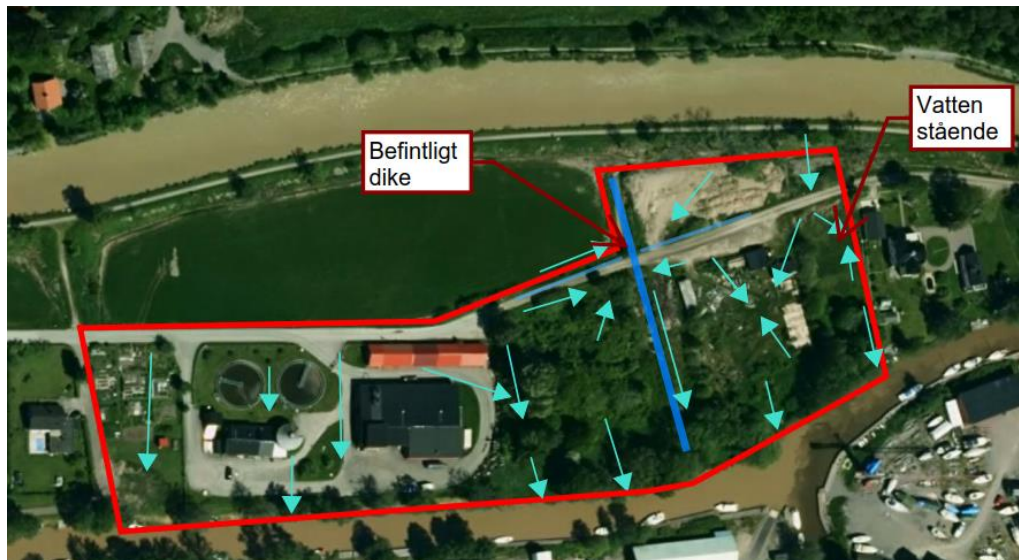
Figur 6) Ytlig avrinning (pilar) och diken (blå linjer) markerade utifrån befintlig topografi inom planområdet. (Ortofoto hämtat från eniro.se)
