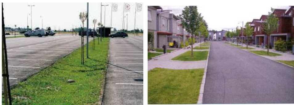
Figur 11) Exempel på infiltrationsstråk för avvattning av parkering respektive gata. Bilder hämtade från Svenskt vatten P105.
