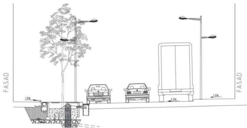
Figur 20) Principskiss på gatusektion med kantsten och avrinning mot skelettjord.
