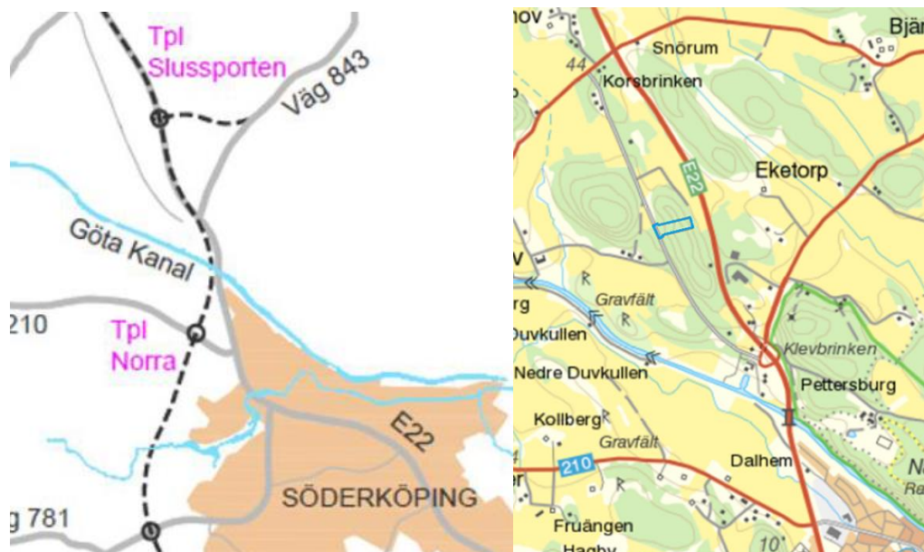
Figur 1: T.v. Översiktsskarta som visar ny sträckning för väg E22 samt trafikplats Slussporten och väg 843. T.h. blå markering visar bergsskärningens läge mellan väg E22 och gamla riksvägen i höjd med Eketorp.
